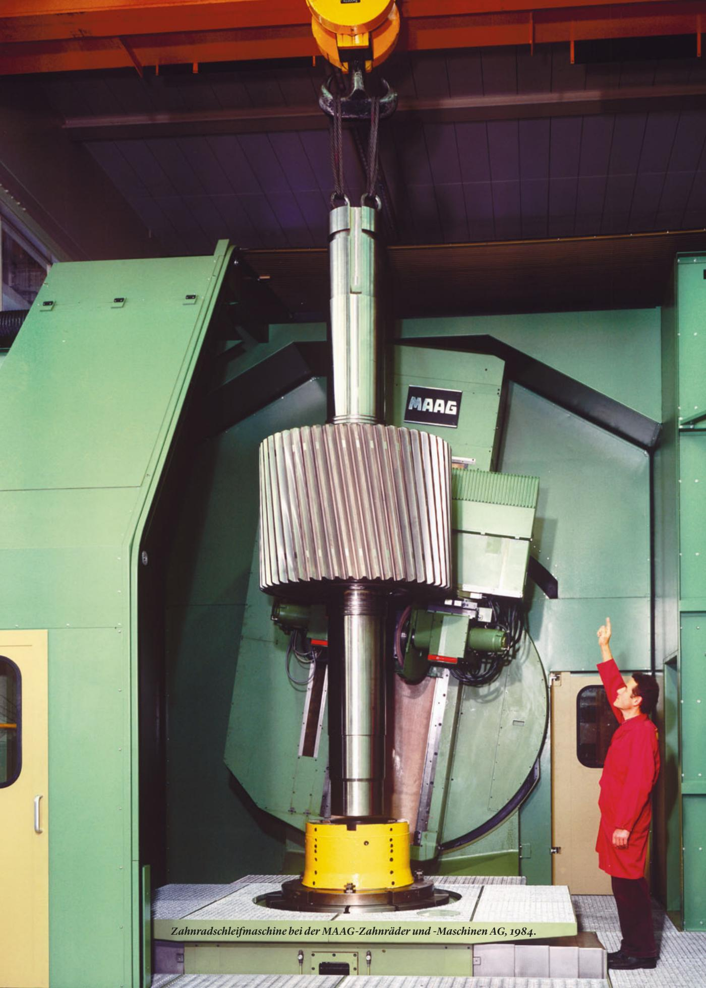
*Zahnrad Schleifmaschine bei der MAAG-Zahnräder und -Maschinen AG, 1984.*
