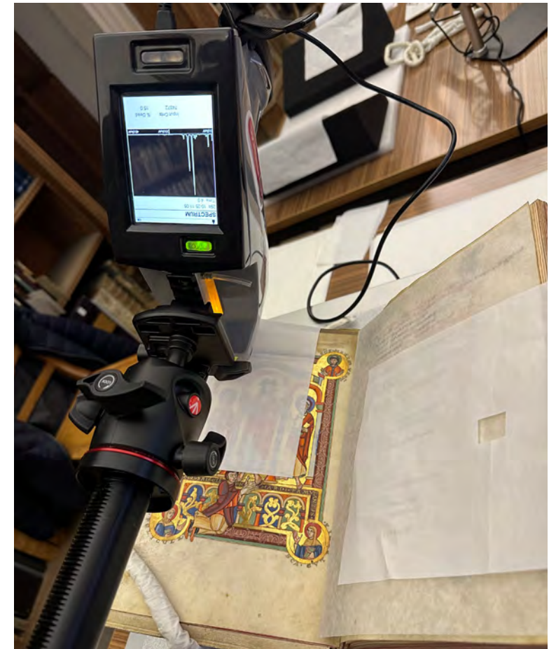
Analyses non destructives au moyen d'un analyseur XRF portable sur les textes sacrés conservés à la Staatsbibliothek de Bamberg.
